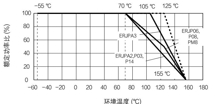
·当工作额定端子部温度, 请按照下图的负荷降低曲线来减少额定功率。
