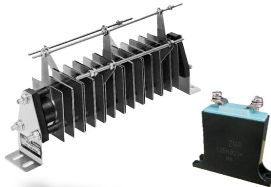
用于电力控制用晶闸管的电涌保护，在传统E型基础上，根据标准电源电压，将ZNR元件串联排列形成的J型标准化产品。与传统瞬间电涌吸收器相比，体积小，限制电压特性卓越，耐气候性佳。根据变压器容量，小型设备使用E型，大型设备使用J型。
