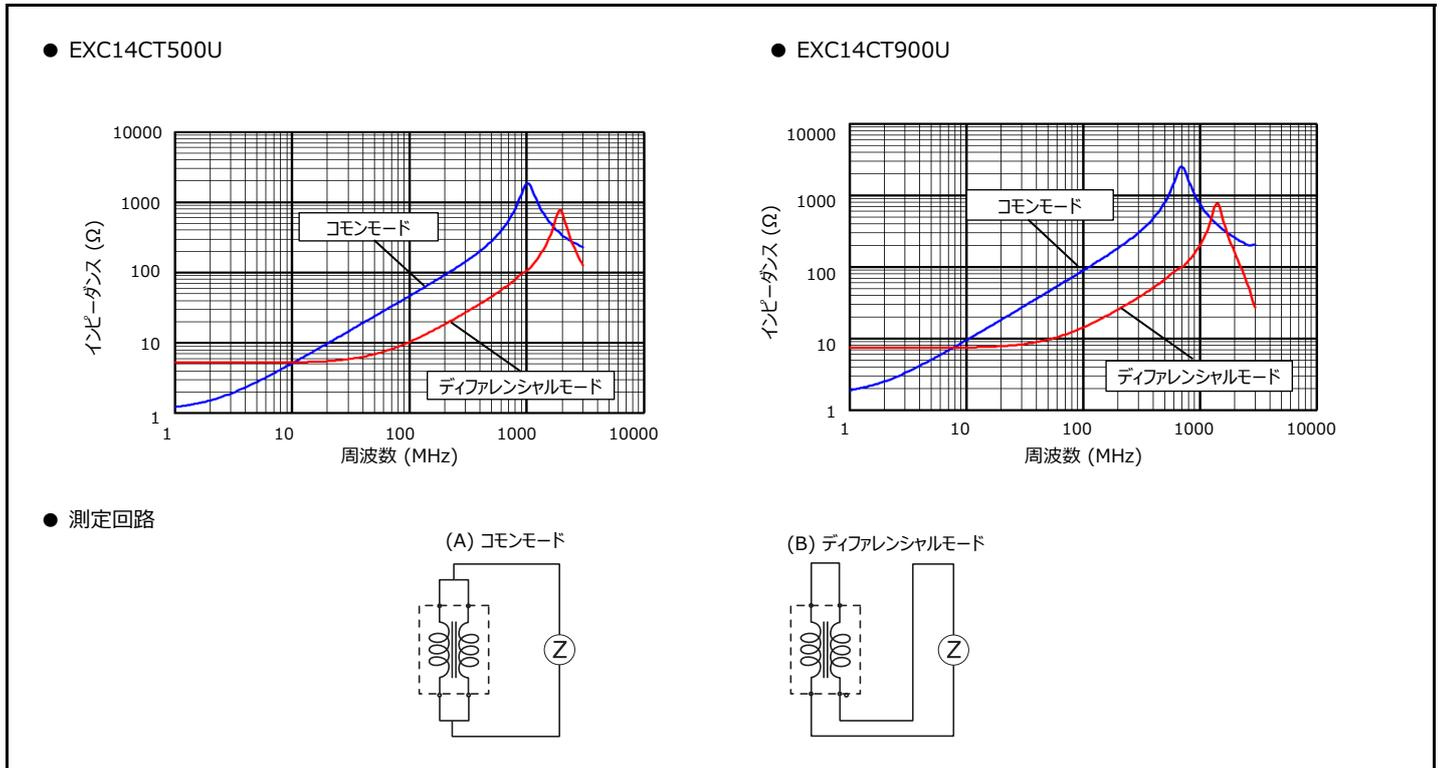
コモンモード減衰特性( $S_{cc21}$ )・ディファレンシャルモード挿入損失特性( $S_{dd21}$ ) (参考特性)
