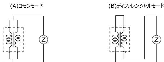
コモンモード減衰特性( $S_{cc21}$ )・ディファレンシャルモード挿入損失特性( $S_{dd21}$ ) (参考特性)
