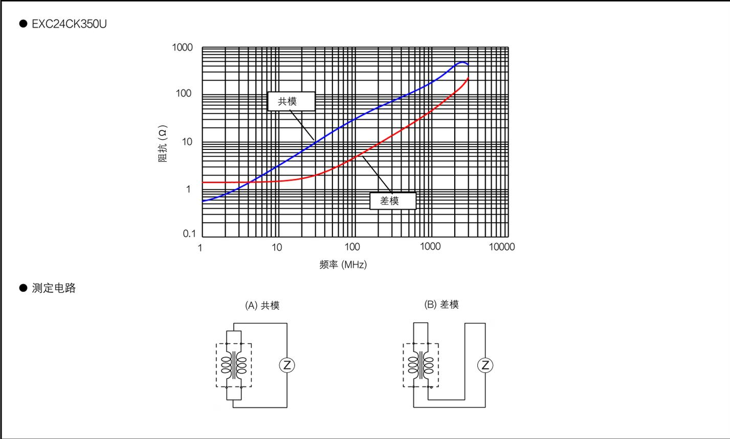
**共模衰减特性 (Scc21), 差模插入损耗特性 (Sdd21) (参考数据)**
