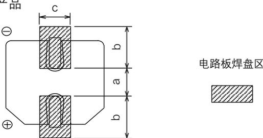
(推荐电路板焊盘尺寸)
