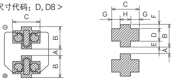
(推荐电路板焊盘尺寸)
